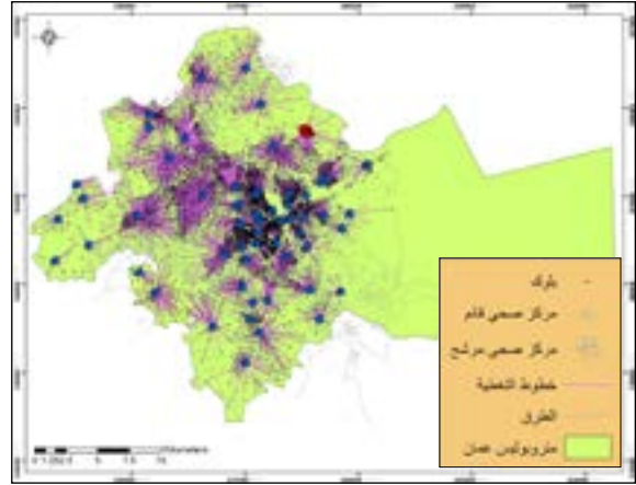
الشكل (11) نتائج تطبيق نموذج الحد الأدنى للمسار الأقصر بين البلوكات ومراكز الرعاية الصحية الأولية لتحديد المواقع المرشحة ضمن مسافة (5) كلم
