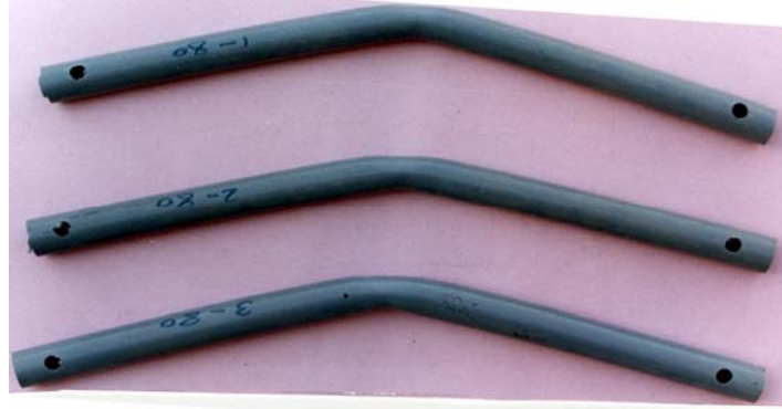
(شكل ٢ - ج): صورة فوتوغرافية لعينات PVC تم اختبارها عند درجة حرارة ٨٠ 0 م.
