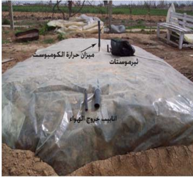
شكل (2) : كومة الكومبوست وميزان الحرارة والترموستات وفتحات التهوية
