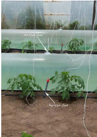
شكل (6) : موازين حرارة التربة والماء المثبتة في وسط أنابيب المياه وبجانبيها
