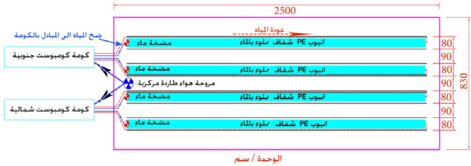
شكل (5) : يبين أنابيب المياه ومضخات المياه ودارة المياه ومضخة الهواء الطاردة المركزية
