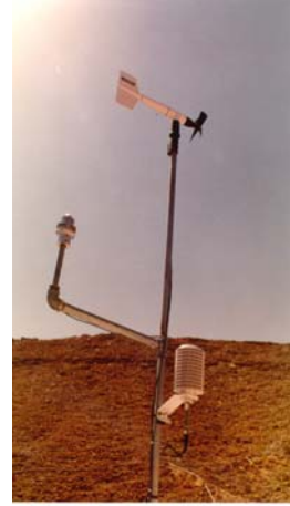
شكل (٧) صورة لمحطة الأرصاد وجامع القراءات الحاسب والذي يقوم بتسجيل وحفظ البيانات
